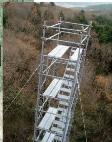
図 2 高さ25mの観測鉄塔 風速、湿度、光量子密度などの気象 が連続測定されています
