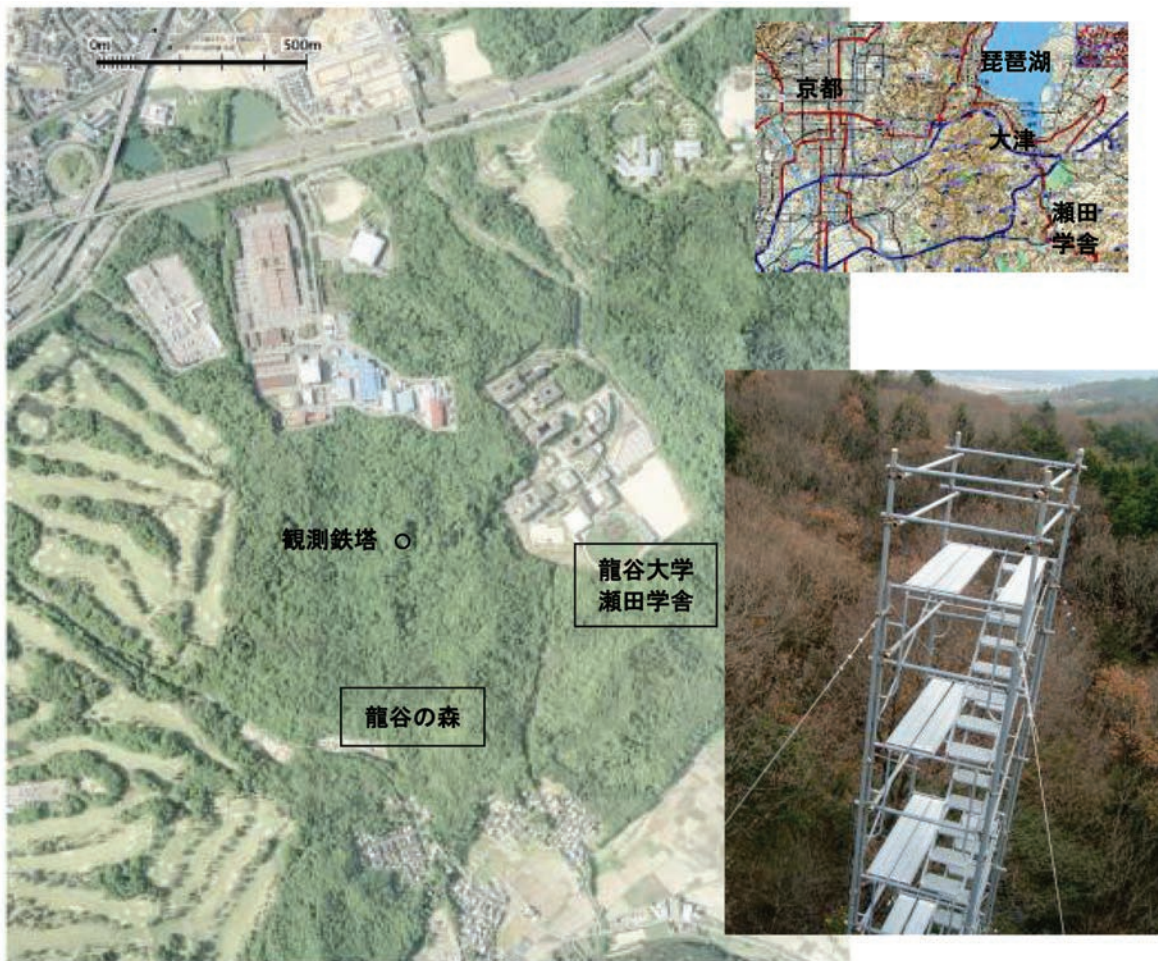
図 2 高さ25mの観測鉄塔 風速、湿度、光量子密度などの気象 が連続測定されています
