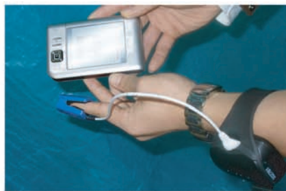
ExS実装(左上:GPS付きPDA 右下:無線脈波センサ)
