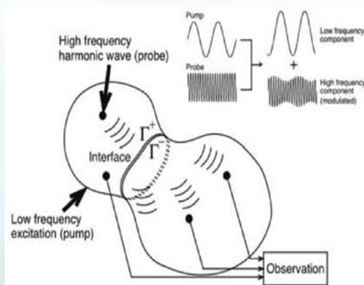
かつ微小な損傷の検出法として非線形波動変調法がありますが、送信と最低2枚の受信用圧電素子を必要とし、センサーのセッティングに問題がありました。本手法は、ベースラインデータ不要で送受信一体センサーを使用した**非線形圧電インピーダンス変調法**を使用しています。
