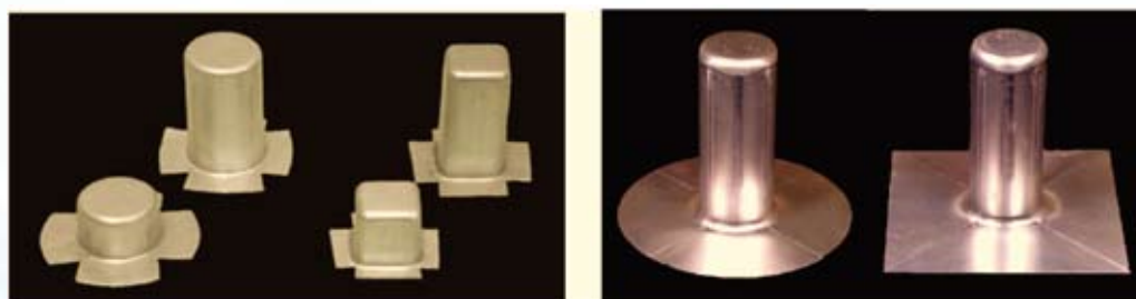
ブランク 初絞り 再絞り・しごき 変形大・絞り抵抗大
