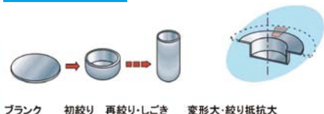
ブランク 初絞り 再絞り・しごき 変形大・絞り抵抗大
